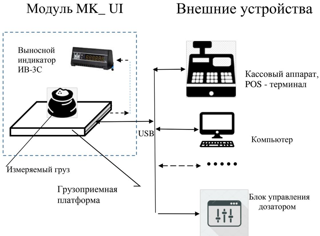
Рис. 1.1 Варианты подключений модуля
